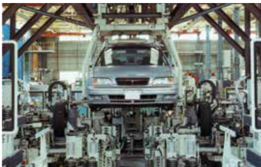
全自動タイヤ取付・締付装置
